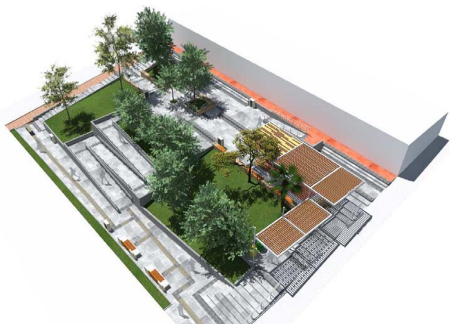
Las obras contemplan la construcción de áreas de permanencias y circulación interconectadas por escaleras y rampas, además de un sombreadero.
